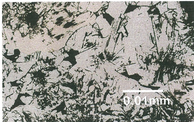
3.2. a) TD-R18 - L.R. Arsenopirite, provável loellingite e pirite.
