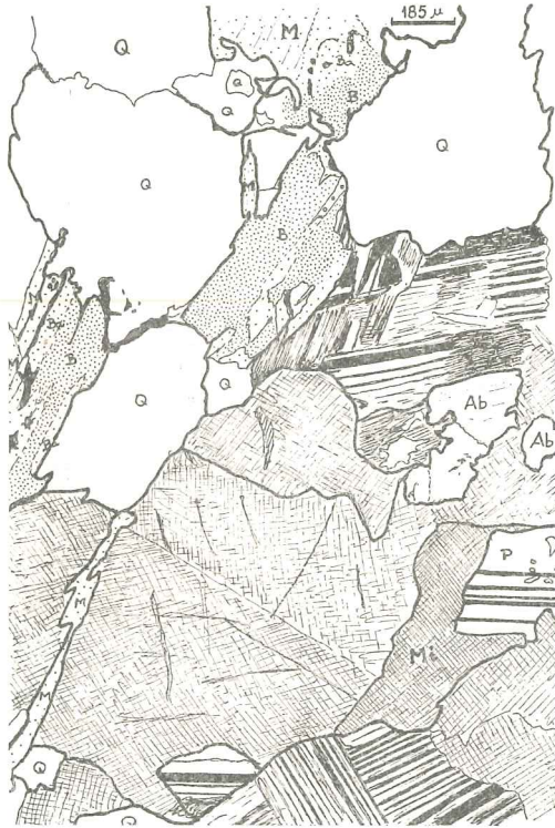
Fig. 12 — Aspecto da textura do granito de Cerdeira. (Q = quartzo; Mi = microclina; P = plagioclase; Ab = albite; B = biotite; Ba = biotite alterada; M = moscovite).
