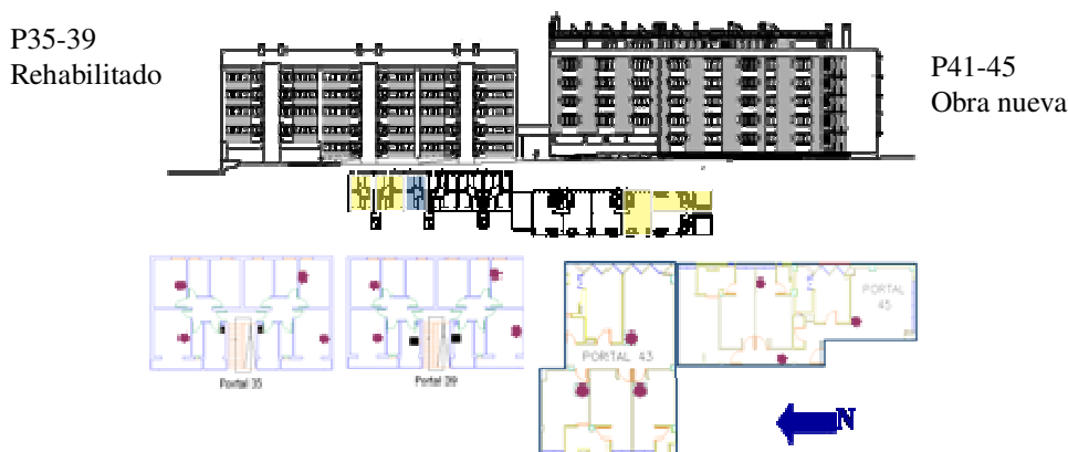
Fig.13. Esquema de la monitorización, posicionamiento de los sensores.
