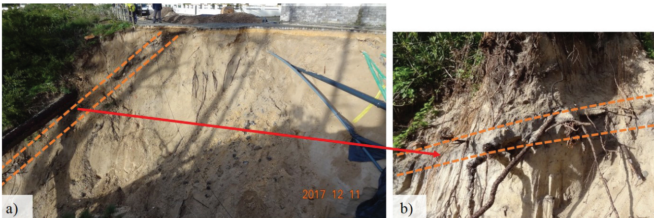
Figura 3. (a) inclinação da camada de areias de cor cinza no limite norte do deslizamento; (b) pormenor das areias de cor cinza com matéria orgânica intercalada com as areias eólicas.
