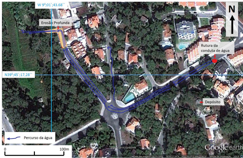
Figura 4. Trajeto do escoamento de águas após a rutura da conduta (GoogleEarth).
