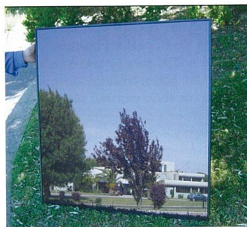
Figura 3 Módulo de Silício Amorfo do parque de estacionamento do Edifício Solar XXI (Foto do LNEG).
