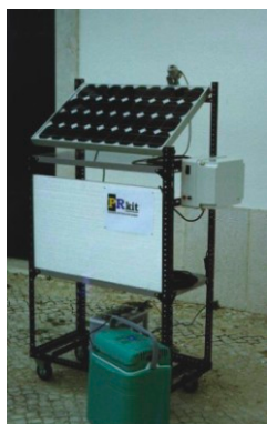
Figura 2- Arca para transporte de vacinas com alimentação solar fotovoltaica.
