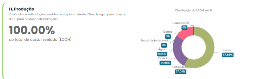
Figura 4.4: Resultado obtido para o LCOH para o caso de referência a usando a Ferramenta LNEG-LCOH. A figura mostra a parcela de CAPEX, OPEX fixo, substituição do stack , eletricidade, água e custos nivelados de combustível em relação ao total de LCOH.
