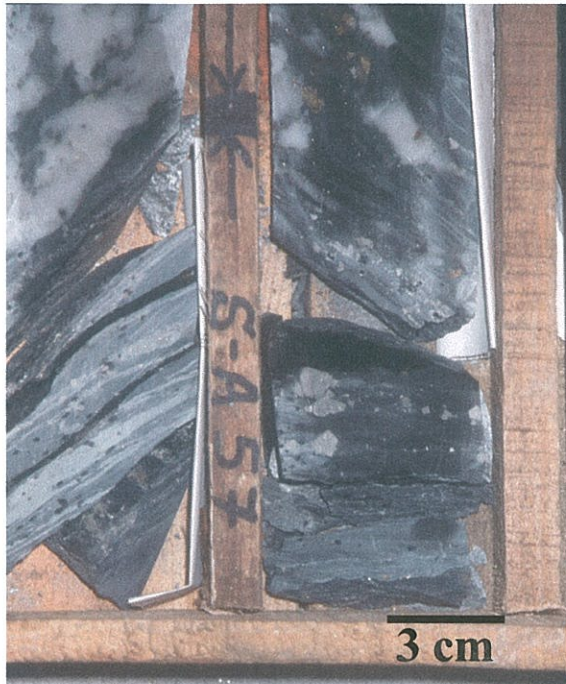
Figura 2 - Testemunho da sondagem A. Xistos com sulfuretos (arsenopirite e pirrotite, calcopirite menor) e quartzo.
