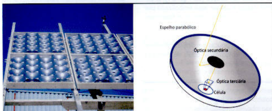
Figura 3 Óptica do tipo Reflexão utilizada na tecnologia Solfocus (C=650) | (foto do autor)
