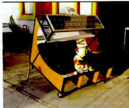
Figura 8 Sistema estacionário de concentração fotovoltaica com concentrador CPC assimétrico (INET/LNEG) | (foto INET).
