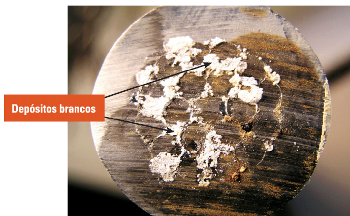
Fig. 5 - Aspecto da superfície de corte na zona encastrada após alguns dias de exposição ao ar, \approx 3x .
