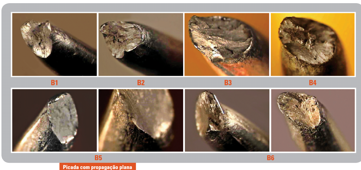
Fig. 8 - Superfícies de fractura dos arames com superfícies de fractura irregulares e estricção. Lado da rotura na zona não encastrada.
