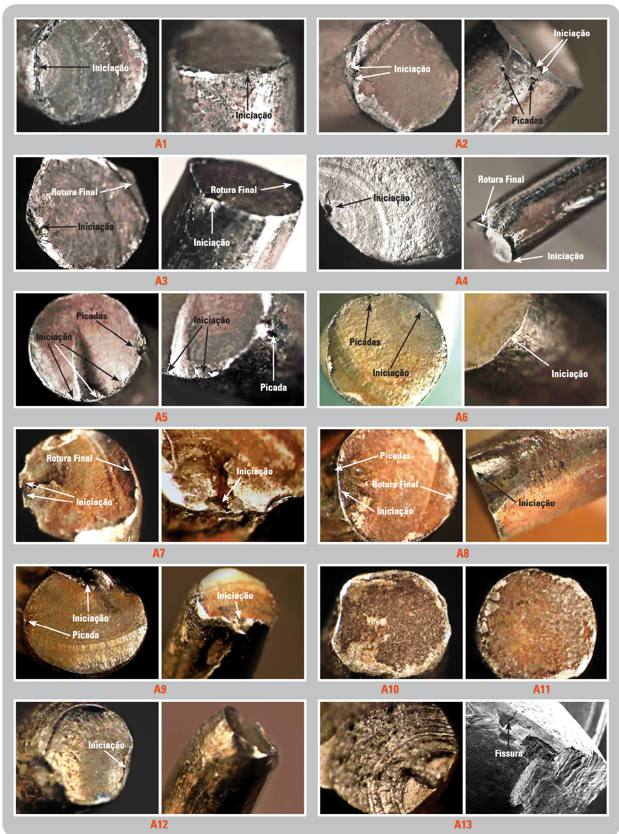
Fig. 7 - Superfícies de fractura dos arames com superfícies de fractura total ou parcialmente planas. Lado da rotura na zona não encastrada.
