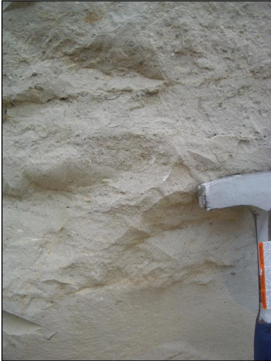
Figura 11- Variação litológica, numa mesma bancada, de calcário de grão fino na parte inferior (packstone intraclástico) para calcário de grão grosseiro com laminações paralelas na parte superior (rudstone biointraclástico).
