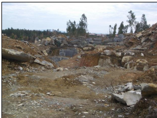
Figura 7- Vista parcial da Pedreira 2 sendo visível o seu aspeto desorganizado, com entulho entre as várias frentes de exploração.
