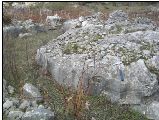
Figura 14- Outro aspeto dos afloramentos em que é preceptível a sua constituição por mais do que uma bancada. O espaçamento entre fraturas é métrico, tal como a abertura dessas fraturas, pelo menos superficialmente.
