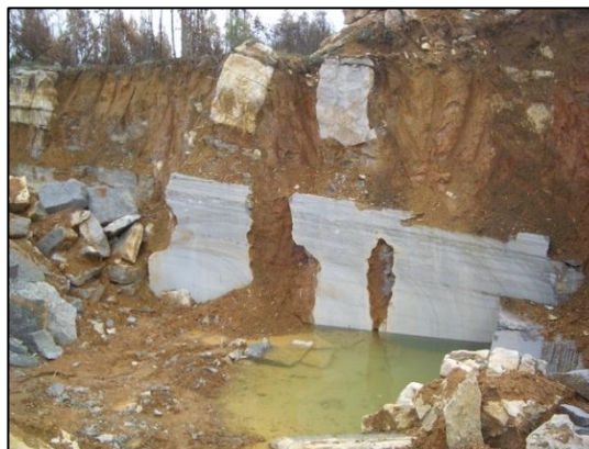
Figura 8- Frente de exploração com cerca de 7 m de altura, na Pedreira 2.
