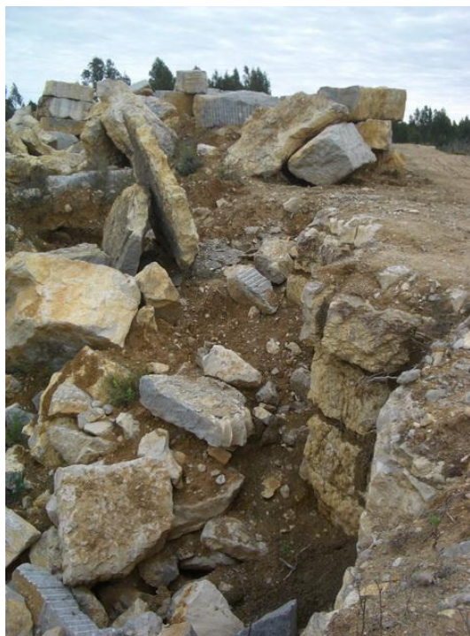
Figura 6- Frente de exploração parcialmente entulhada na Pedreira 1.
