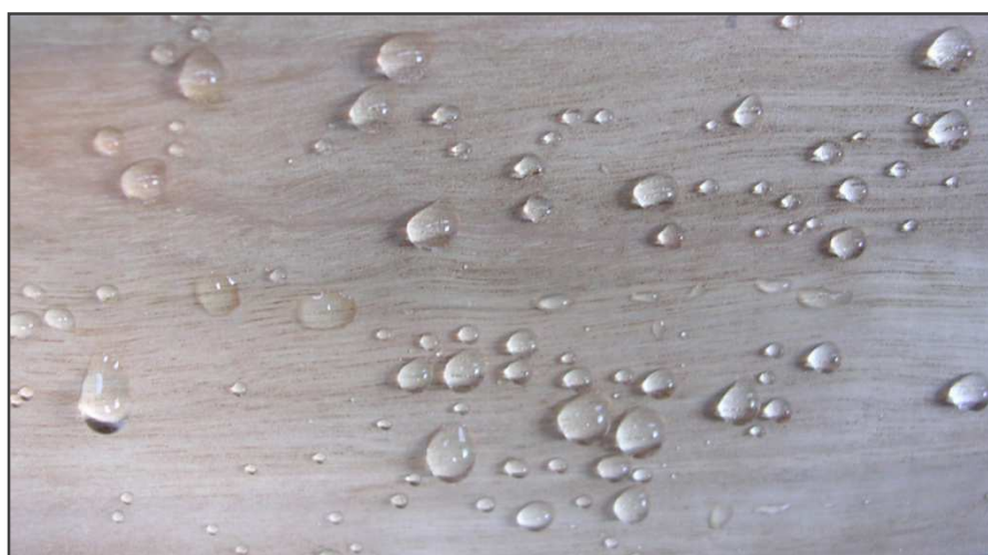
Figura 13 – Repelência à água na superfície do eucalipto induzida por tratamento químico.
