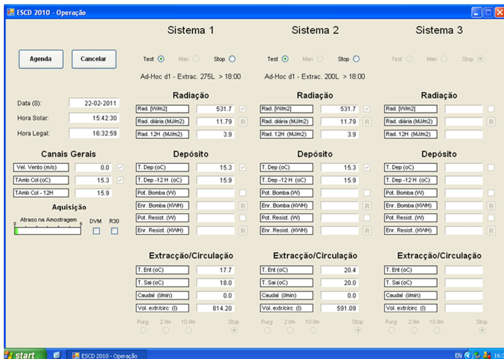
Figura 20 – Quadro de operação do software de aquisição de dados. São registadas as temperaturas de entrada e saída da água no depósito, caudal e volume extraído. As extracções são realizadas sempre de acordo com a hora solar. É também indicada a temperatura ambiente e irradiância a cada instante de aquisição.
