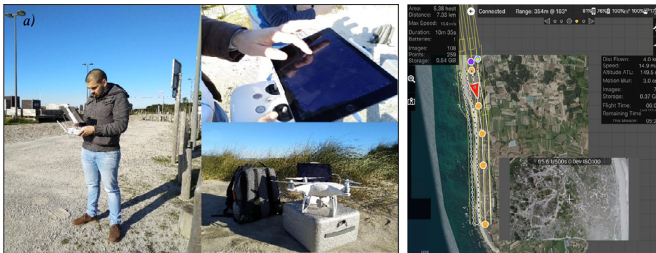
Figura 1. Realização de levantamentos fotográficos com recurso a veículo aéreo não tripulado (VANT): a) operação do VANT DJI Phantom 4 RTK para levantamento fotográfico; b) aspeto da interface do software Map Pilot durante voo do VANT na praia do Belinho (Esposende).
