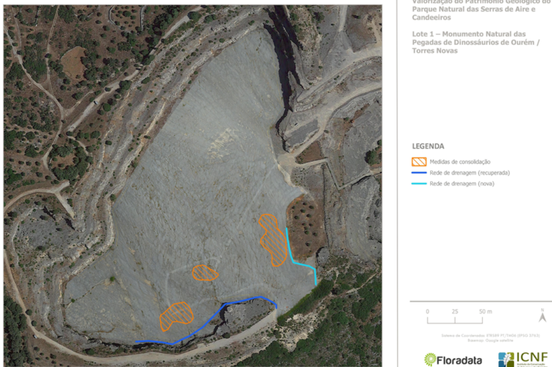
Figura 5. Medidas de Geoconservação (rede de drenagem nova e recuperada e áreas de consolidação) propostas para o MNPDOTN.
