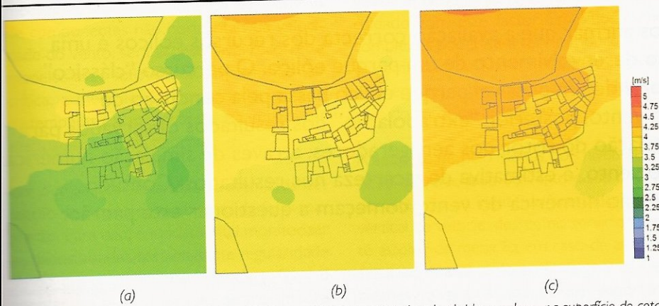
Figura 9 Velocidade do vento (a) 10 m (b) 16 m e (c) 20 m acima do solo obtida com base na superfície de cotas gerada acima dos edifícios – estimativa W.URBan.
