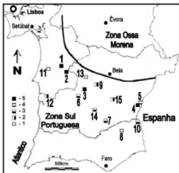
Figura 2 – Perigosidade ambiental em áreas mineiras da Faixa Piritosa Ibérica [35,45]: 5 – grau máximo, 1 – grau mínimo. Áreas mineiras: sulfuretos maciços: 1 – Caveira, 2 – Lousal, 3 – Aljustrel, 4 – São Domingos, 5 – Chança, 6 – Montinho; Cu filoniano: 7 – Barrigão, 8 – Ferrarias, 9 – Juliana; Sb filoniano: 10 – Cortes Pereiras; óxidos Mn, Fe: 11 – Saramaga, 12 – Cercal, 13 – Lagoas do Paço, 14 – Ferragudo, 15 – Balança.
