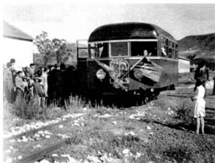
Fig. 7 – A “Zézinha”, automotora a gasolina, construída nas oficinas da EML, servia ao transporte dos quadros da empresa. Aut. desc., [194-?]
