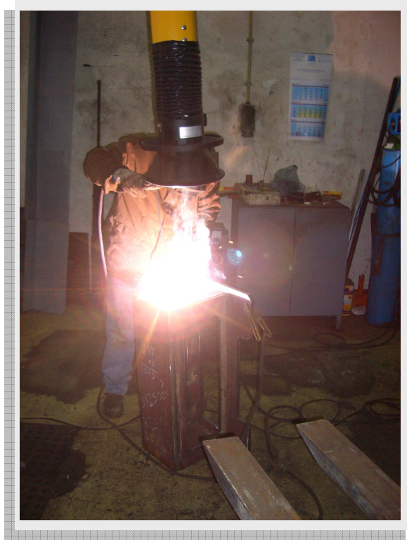
Figura 34 – Exemplo de processo de soldadura com exaustão de fumos (Empresa Tecnisata).
