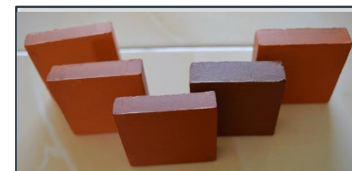
Pó de granito em telhas cerâmicas
