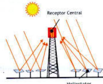
Receptor Central de Torre
