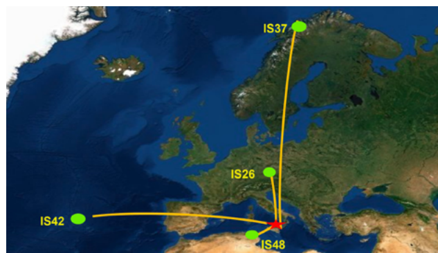
Figura 9. Localização do evento paroxismal no vulcão Stromboli a 3 de julho de 2019, através dos azimutes inversos registados nas várias estações da IMS (Matos et al. , 2020).
