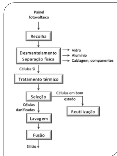
Figura 4 Processo esquemático de reciclagem de painéis fotovoltaicos em fim-de-vida.
