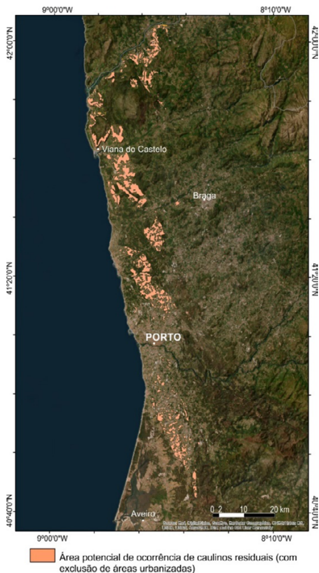
Figura 1. Mapa esboço de áreas potenciais em caulinos residuais na faixa Aveiro - Viana do Castelo, obtido com base em critérios geológicos e geomorfológicos, e exclusão de área esterilizada por zonas urbanizadas (a que há ainda a retirar outras áreas de exclusão impeditivas da atividade extrativa).
