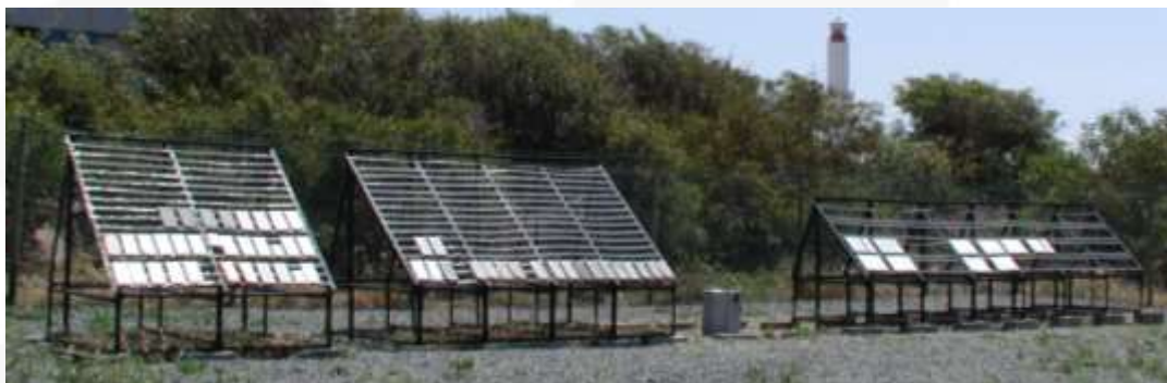
Estação Atmosférica de Sines , Projeto TAPAC – LTR/INETI Exposição Natural de 5 diferentes revestimentos de zinco aplicados em aço.
